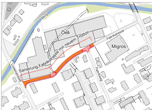
Sanierung und Ausbau Fabrikstrasse mit Trottoir und erhöhten Kreuzungsbereichen zur Verbesserung der Sicherheit für Fussgänger.
