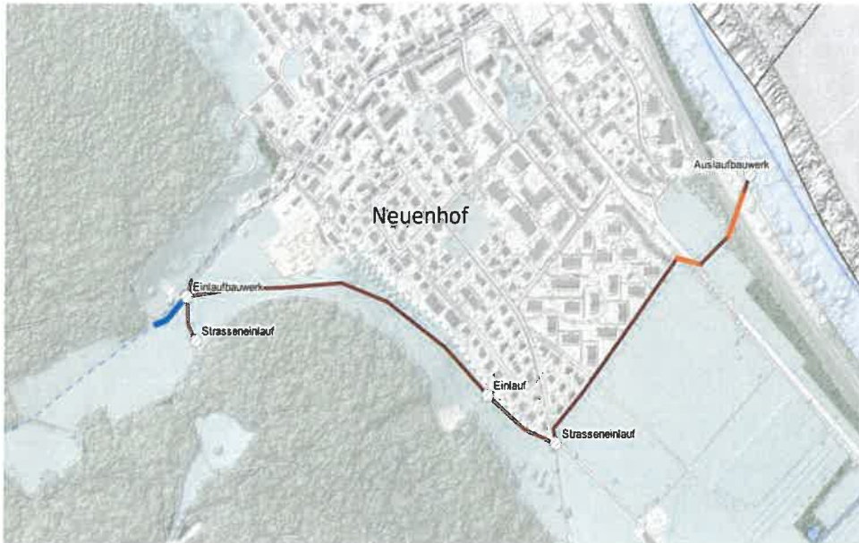
Abb. Mögliche Linienführung Entlastungsleitung.
