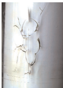
Haarrisse entstehen z.B. durch chemische Reinigungsmittel
