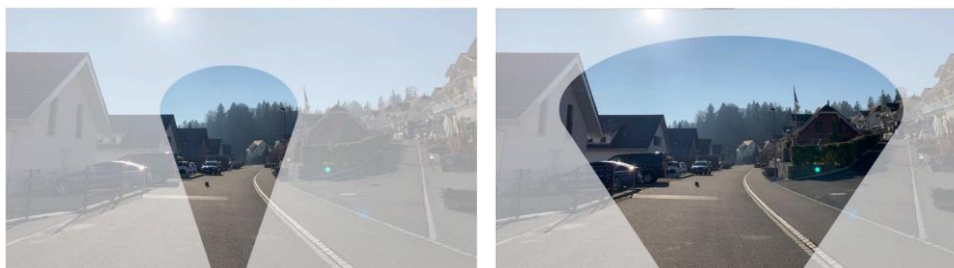
Abb. 14: Vergleich Sichtfelder bei 50 km/h (links) und bei 30 km/h (rechts) (Quelle: Büro Suter • von Känel • Wild)
