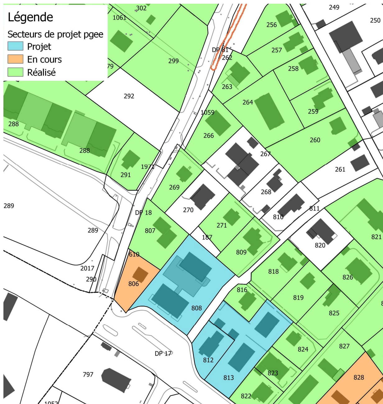
Figure n° 2 : Etat du déploiement du réseau séparatif public dans le secteur du chemin de Belmont - janvier 2023.
