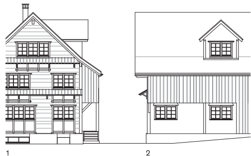
1 Seitenansicht Dachgaube 2 Ansicht Dachgaube mit durchlaufender Traufe
