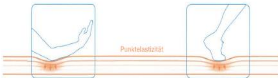
Abb. 1: Kurzerklärung punktelastischer Sportboden
