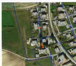
A Localisation des fuites sur le réseau conduite existante
