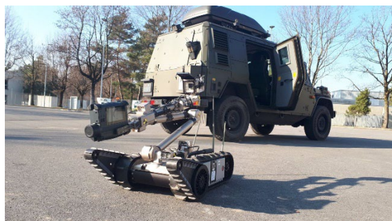
Figure 4 Robot d'exploration équipé d'un appareil de radiométrie portable
