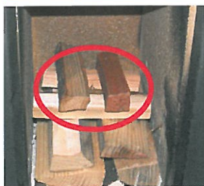
Camere di combustione strette: posizioni i ciocchi con la cima rivolta verso di lei.
