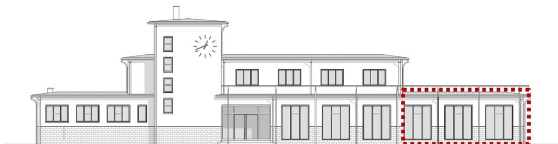
Teilrückbau des Aufnahmegebäudes, Nordfassade
