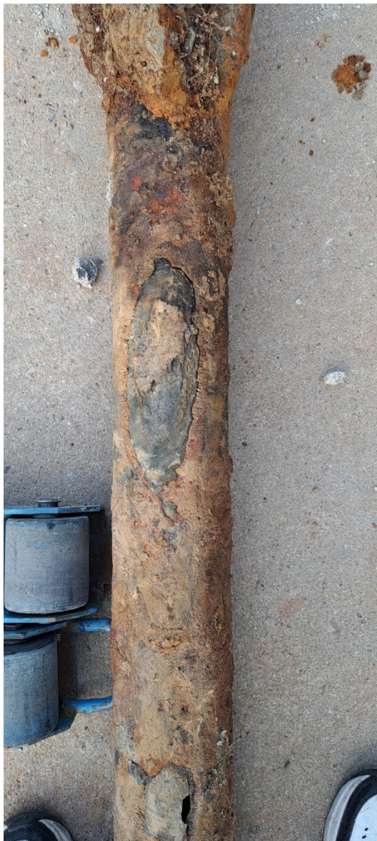
Fig. 2 et 3 – degré de dégradation de la conduite
